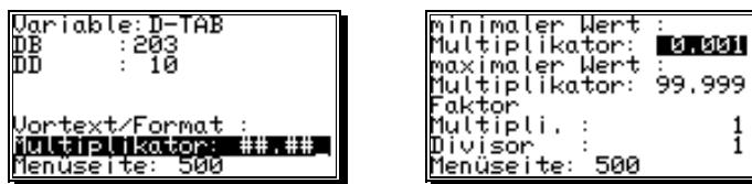
Die Variable "D-TAB" wird zur einfachen Eingabe von Systemparameter verwendet und benötigt insgesamt 7 Parameter:
