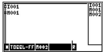
Merker 2 wird mit jeder positiven Flanke an Eingang 1 umgeschaltetet.
