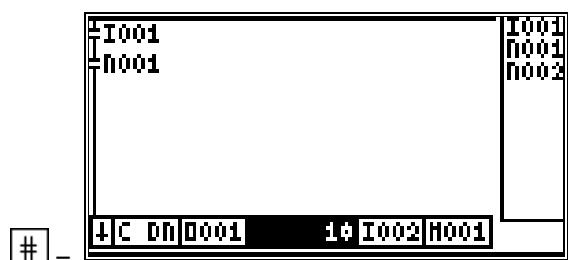
Nach Eingabe des Zählerwertes, die im Bereich von 0..9999999 liegen kann, wird durch das Betätigen der Taste **CR** der Wert übernommen und in die Eingabe der Zählerresetbedingung weiter gesprungen.
