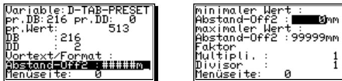
Die Variable "D-TAB-PRESET" wird zur einfachen Eingabe von Parametern des SPS - Logik - Moduls verwendet und benötigt insgesamt 10 Parameter:
