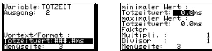
Die Variable "TOTZEIT" wird zur einfachen Eingabe und Anzeige der programmierten Totzeit eines Nockenausgangs benötigt. Es sind insgesamt 6 Parameter notwendig:
