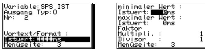
Die Variable "SPS IST" wird zur einfachen Eingabe und Anzeige von Istwerten der Zeiten und Zählern des SPS - Logik - Moduls benötigt. Es sind insgesamt 7 Parameter notwendig:
