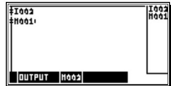
Merker 2 wird für einen Zyklus eingeschaltet wenn das Signal am Eingang 2 von 1 auf 0 wechselt.
