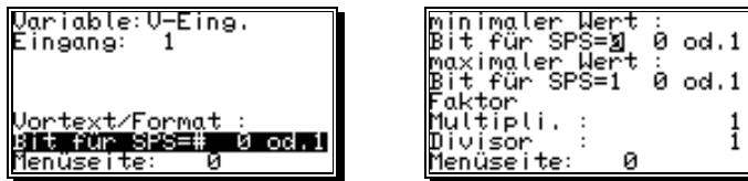
Die Variable "V-Eing." wird zum Beeinflussen der V-Eingänge des SPS - Logik - Moduls benötigt. Durch die Eingabe einer 0 oder einer 1 wird der V-Eingang entsprechend gesteuert. Es sind insgesamt 6 Parameter notwendig:
