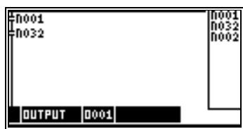
Ausgang 1 des CamCon wird freigegeben, wenn der Drehrichtungsausgang 32 eingeschaltet ist.
