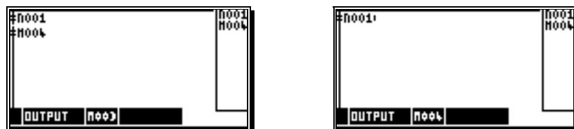
Wird die Nocke N001 ausschaltet, (negative Flanke) wird Merker M005 zurückgesetzt.
