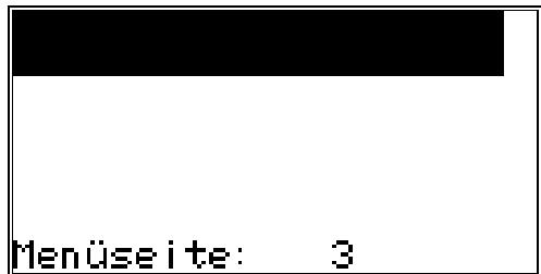
Durch die Tasten **▼** und **▲** wählen Sie nun die Zeile aus, die Sie bearbeiten möchten und bestätigen Sie diese mit der **CR** Taste. Wird die Zeile 1,2 oder 7 ausgewählt, so kann die Zeile entweder als "1 Text" oder als "2 Variablen" Zeile definiert werden und kann somit als Überschrift verwendet werden.
